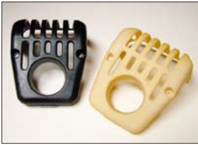
ZPrinter 310 Plus 打印制作的消声器护板
