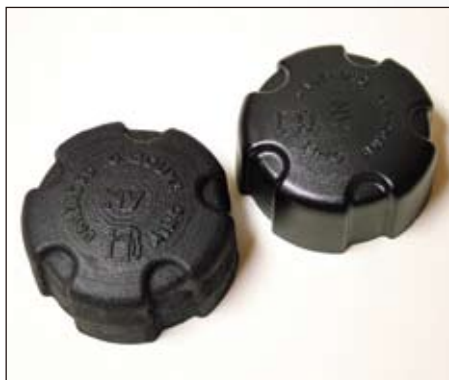
采用 ZPrinter 310 Plus 打印的油箱盖和原型
